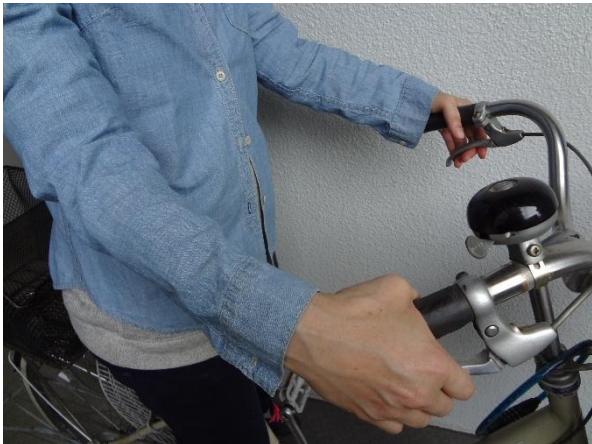
腕の曲がりが小さい ハンドルの高さが適正 ハンドルに力が入りやすくバランスが取りやすい
